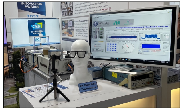
그림 1 밀리미터대역 소프트웨어 정의 라디오를 이용한 실시간 안경형 투명 안테나 프로토타입 데모 (CES 2023 Innovation Award)
